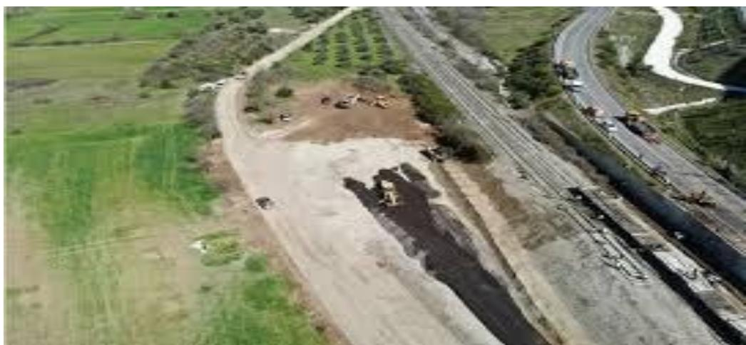
Κυρίως όμως το σημείο στο οποίο είχαν καταπέσει τμήματα(συντρίμμια) της επιβατικής αμαξοστοιχίας , αλλά και απόβλητα ή κατάλοιπα καύσης παρασυρμένα από τα νερά πυρόσβεσης , ίσως όμως και βιολογικό υλικό ανθρώπων , μπαζώθηκε με επιμελή και μόνιμο τρόπο , δηλ. αφαίρεση του χώματος σε ικανό βάθος , πάχτωση του με χοντρά εμποτισμένα χαλίκια λατομείου και κάλυψη με σκυρόδεμα επίσης ικανού πάχους.
